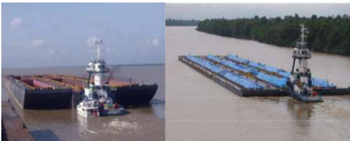
Figura 7.26 – Vista geral do comboio de 9 barcaças para transporte de minério vazias (esquerda) e totalmente carregadas (direita). Fonte: NAGADO, LUKINE e MENDONÇA (2012).
