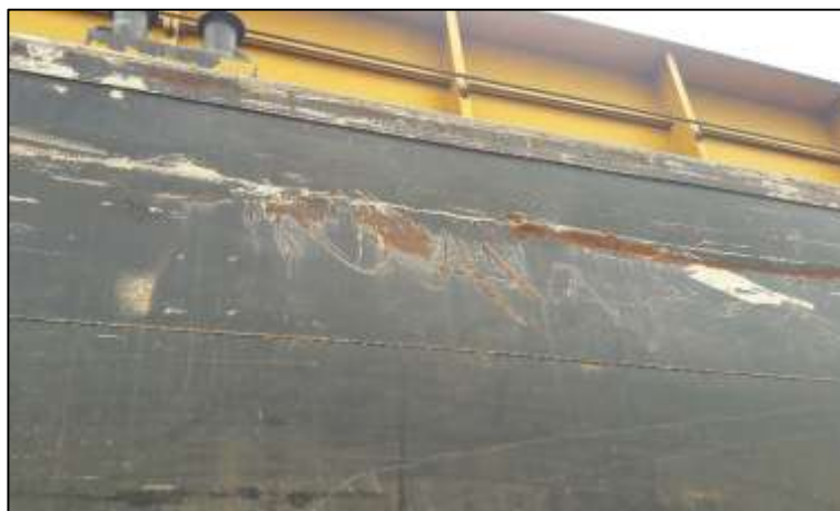
Figura 1.7 – Região do costado onde é possível verificar uma zona de impacto no sentido longitudinal. Fonte: O Autor.
