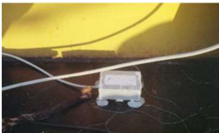
Figura 7.28 – Modelo de acelerômetro posicionado no convés da barça de nº 6 para medição dos movimentos das barças durante o teste. Fonte: NAGADO, LUKINE e MENDONÇA (2012).
