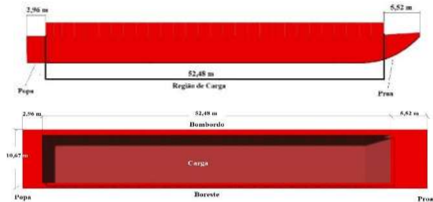
Figura 5.2 – Ilustração das Dimensões dos modelos de Barças Raked. Fonte: O Autor.
