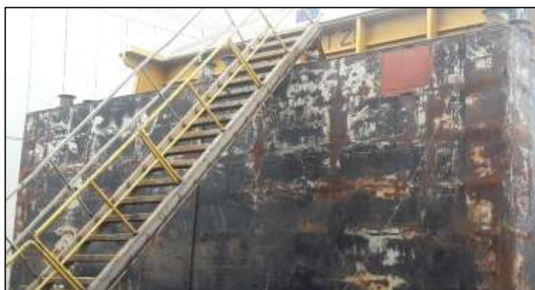
Figura 1.8 – Região do espelho de popa da barça, atentando para o formato de popa Box da barça. Fonte: O Autor.
