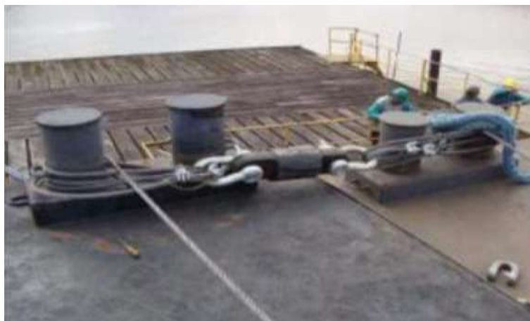
Figura 7.29 – Modelo de célula de carga utilizada para medir os índices de tensões presentes nos cabos de amarração das barcaças. Fonte: NAGADO, LUKINE e MENDONÇA (2012).
