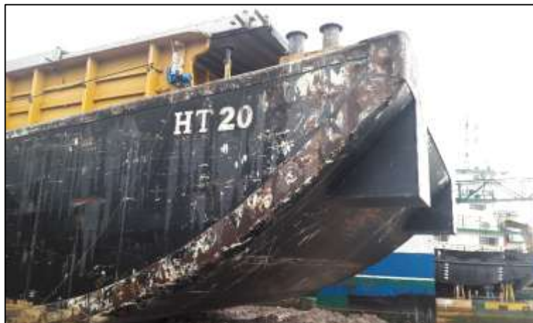
Figura 1.6 – Região de proa de uma barça com proa Raked . Fonte: O Autor.
