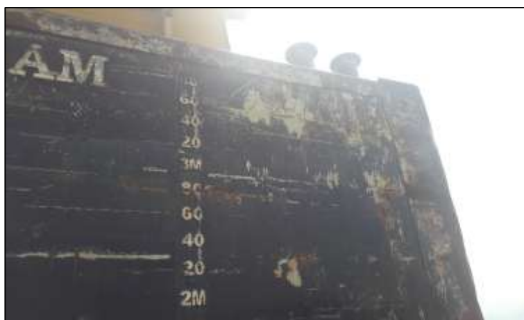
Figura 1.4 – Visualização do costado próximo a proa da barcaça, em destaque as marcas de calado e os cabeços em segundo plano. Fonte: O Autor.
