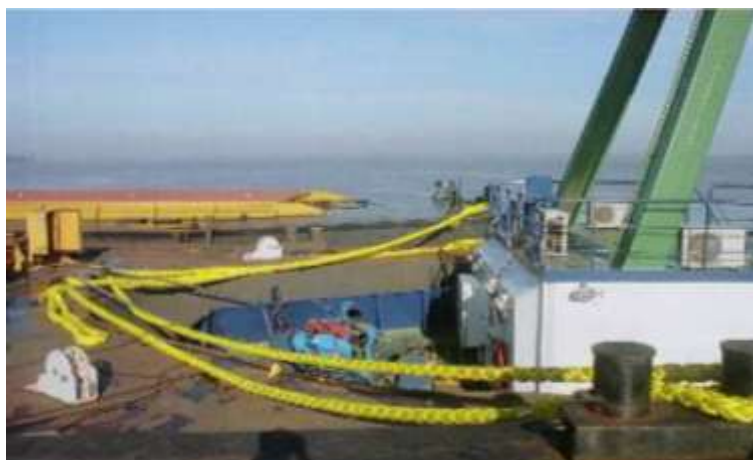
Figura 7.30 – Amarração do comboio utilizando cabos de propileno (cor Amarela) de 4 polegadas. Fonte: NAGADO, LUKINE e MENDONÇA (2012).
